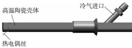
图 3 校准用气冷式高温热电偶
